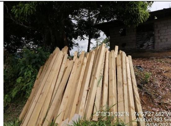
Figura 3.1. Postería en buen estado sin inmunizar trasladados a campo.
